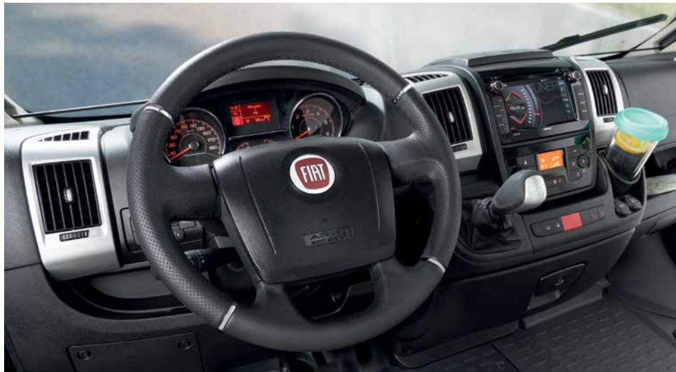
» Førerhus med sportslig utseende, skinntrukket ratt, aluminiumsdekor og instrumentpanel med kromringer. Et viktig sikkerhetskjennemerke er fører- og passasjerkollisjonsputer
