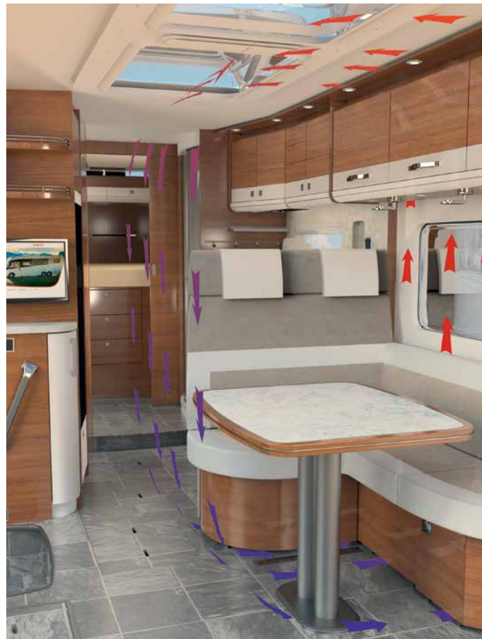
» AirPlus-systemet forhindrer at det dannes kondensvann bak oveskapene
