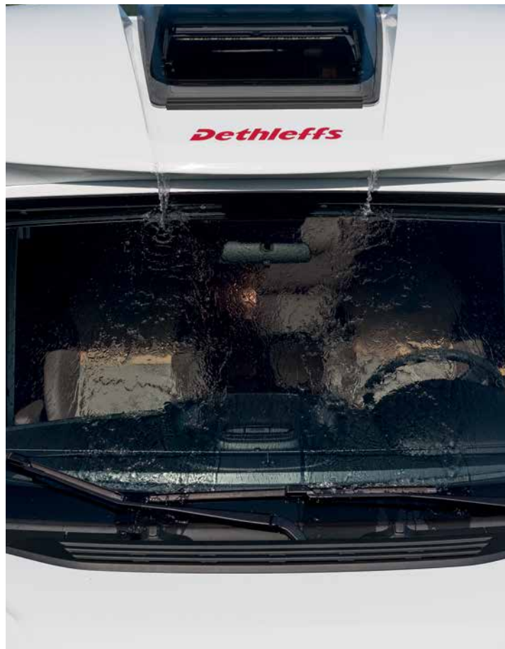
» Regnvann ledes fra taket gjennom definerte kanaler over hekk og frontrute
