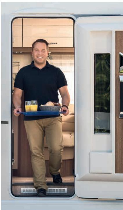
» Ekstra bred inngangsdør (70 cm) med sentrallås, sikker 2-punkts-låsning, vindu og myggenetting
