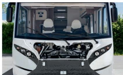
» I: Servicevennlig: Stor motorromsåpning for bedre adgang til alle servicerelevante deler
