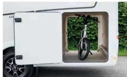
» Høy garasje i bak, som kan lastes fra begge sider med 150 kg flatelast. Standard med to serviceluker
