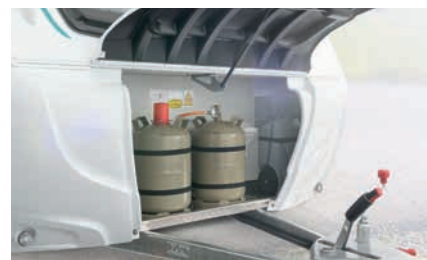
» Gaskasse til 2 x 11 kg gasflasker og med gaskassegulv i råtebestandig alu-riffelplate
