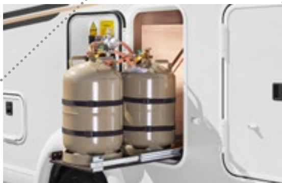
Rom for gassflasker i bakre del med enkel tilgang via separat dør til gassflaskene. Tilvalg: komfortsystem for uttrekk av gassflasker (I 138 DB, I 141 LE, I 143 LE)
