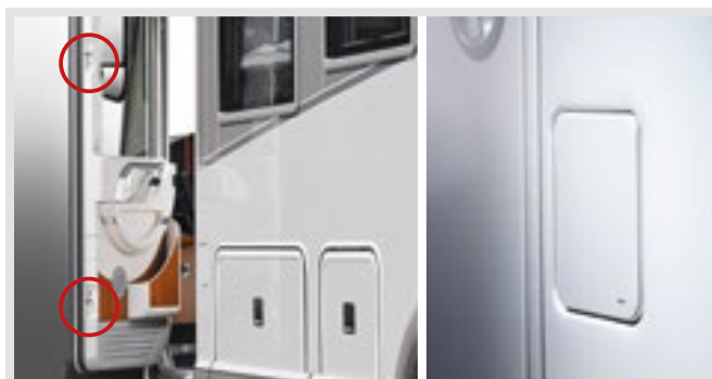
Førerdør med ekstra lavt innsteg og dobbel sikkerhetslås. Lokket for drivstofftanken er felt inn i flukt med sideveggen
