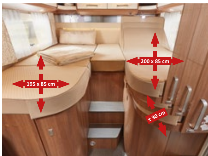
Patentsøkt: Enkeltseng kan forlenges med 30 cm for optimal søvn ved kort kjøretøylengde (I 144 LE)
