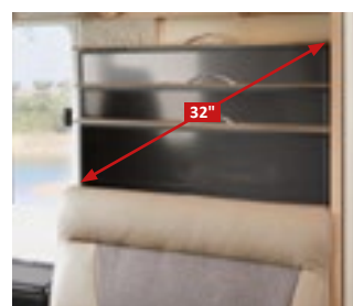
TV-uttrekksystem bak rygglenet for setebenken
