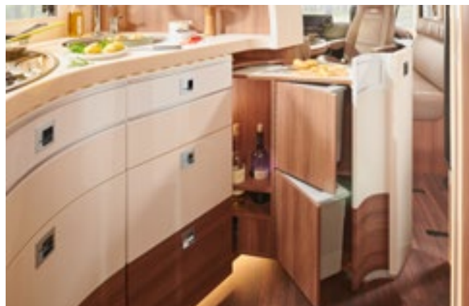
Uttrekkbar kjøkkenbenk med utvidet arbeidsflate, sentrallås, avfallsbeholdere og flaskeholdere
