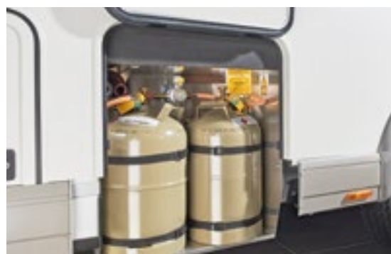
Rom for gassflasker "easy change" , dypt nedsenket for bekvemt skifte av flasker, begge flaskene lett tilgjengelig (ikke i 141 LE, i 143 LE)
