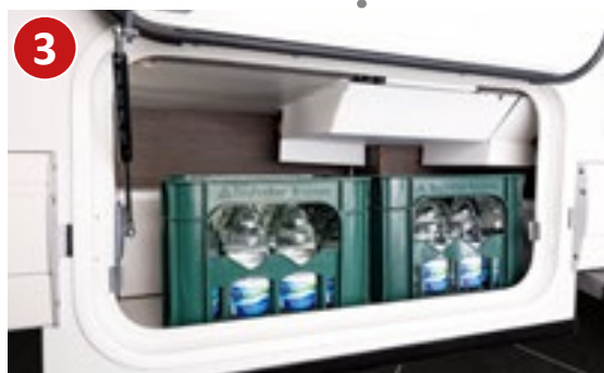
Stort, ekstra lasterom i dobbeltgulfv med separat luke utvendig (på passasjersiden)
