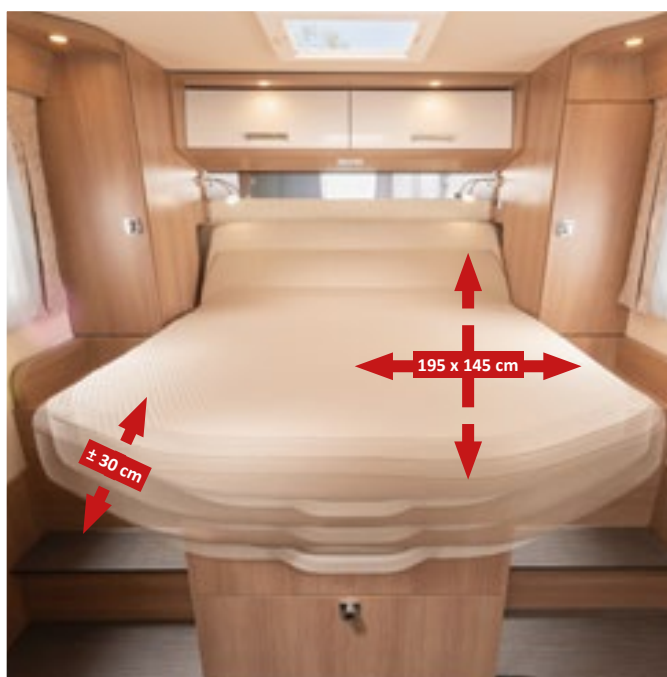
Patentsøkt: Sengemål kan forlenges med 30 cm for optimal søvn ved kort kjøretøylengde (I 144 QB)
