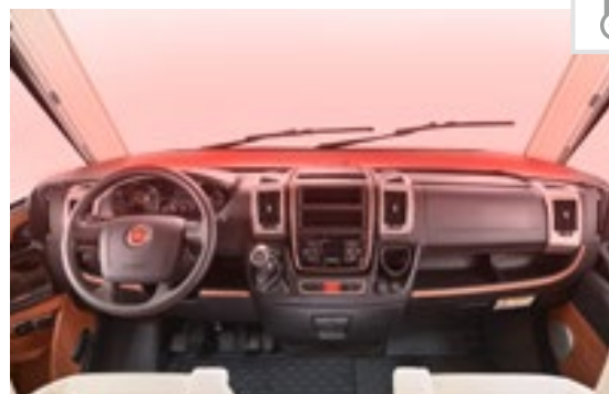
Ekstra oppvarming av førerhusområdet med oppvarmet overflate på dashbordet, gir reduksjon av kulde gjennom frontruten til førerhus/bodel
