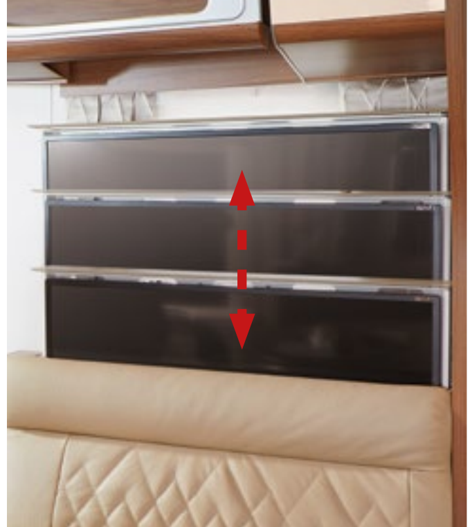
Smarte løsninger: LED-skjermen senkes/heves bak rygglenet
