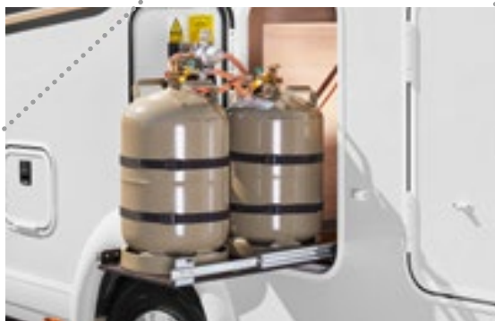
Rom for gassflasker i bakre del med egen dør utenfra (I 143 LE, I 143 LE). Tilvalg: Komfortsystem for uttrekk av gassflasker
