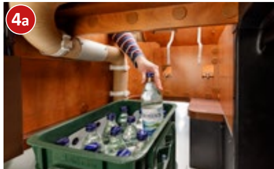
4a Enkel innlasting i oppbevaringsrommet i dobbeltgulvet via stor utvendig luke
