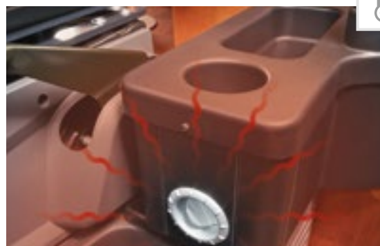
Varmelagring og varmeteknikk Truma Combi 6 med varmluftdyser over hele dobbeltgulvet, i bodelen, i garasjen, i førerhuset og i de kuldeømfintlige dørinnstegene.
