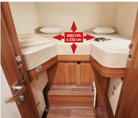
Elektrisk nedsenkbar langsgående enkeltseng med uttrekkbar innstegstrapp og skyvedør til isolasjon mot kulde
