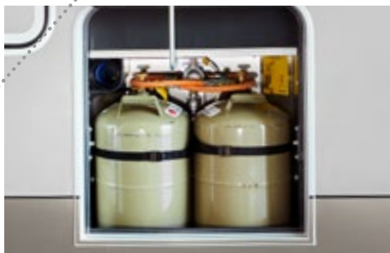
Rom for gassflasker, "easy change", dypt nedsenket gassflaskekaske, enhåndsbetjening av luken for lettvinnt skifte av flaskene som er tilgjengelige enkeltvis
