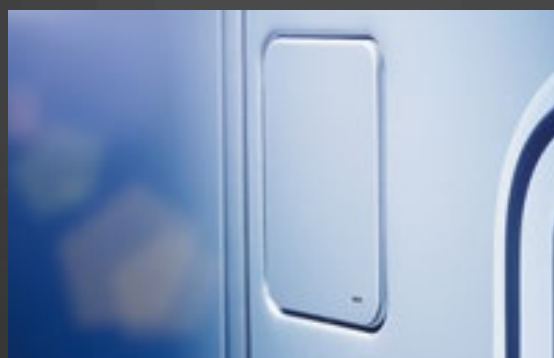
Tanklokket på Carthago er integrert i flukt med overflaten.
