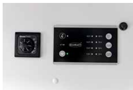
Kontrollpanel ombord Med angivelse av alle nivåer og batterikapasiteter
