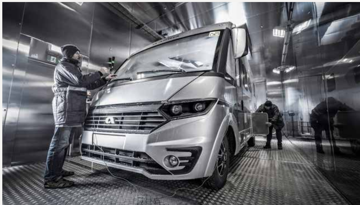
Alle kjøretøy gjennomgår testing i klimakammer.
