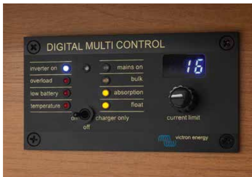
+ Victron Energy Digital MultiControl med styrepanel over inngangsdøren til bodelen (ekstrastyr) (4)
