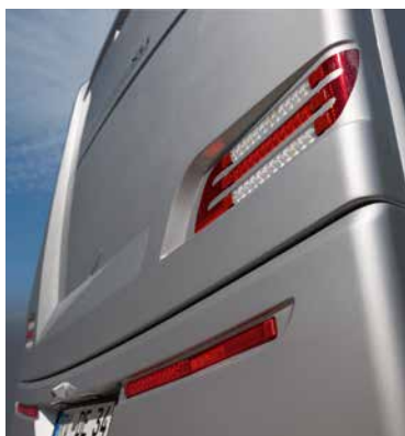
+ Reparasjonsvennlig: Todelt GFK-hekk (1)
