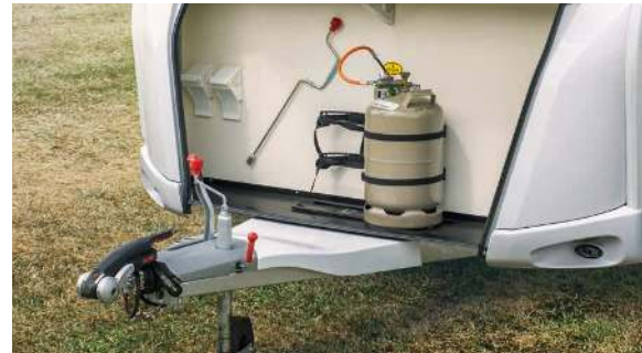
Gas bottles stored in the front garage. / Gasflessen in de gasflessenkast voorin. / Gasflasker i gaskassen.
