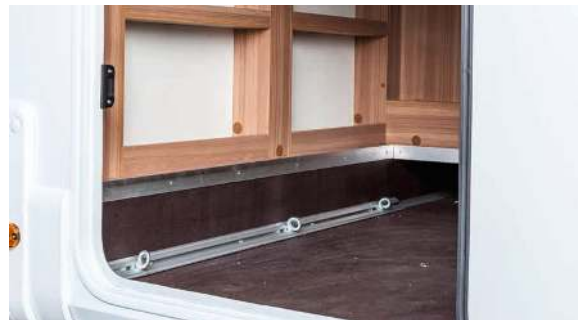
Rear garage with integrated lashing eyes. / Achtergarage met geïntegreerde vastsjorogen. / Baggarage med integrerede fastsurringsringe.
