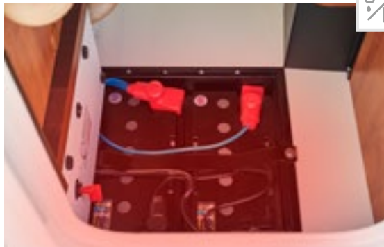
Oppvarmet batterisentral med batterihovedbryter. Standard: 2 x 80 Ah gelbatterier. 90 Ah Li-Ion-batteri som tilvalg, inkludert battericomputer
