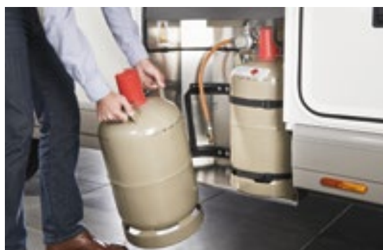
Gassflaskerom "easy change" , dypt nedsenket for bekvem bytting av flaskene (unntatt T 143 LE)
