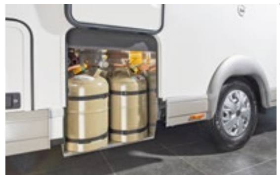
Gassflaskerom "easy change", dypt nedsenket for bekvem bytting av flaskene
