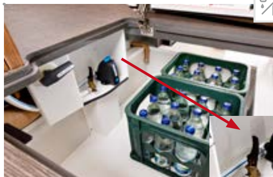
Vannavløpssentral under dobbeltgulvet – kan også betjenes utenfra gjennom bodelsdøren
