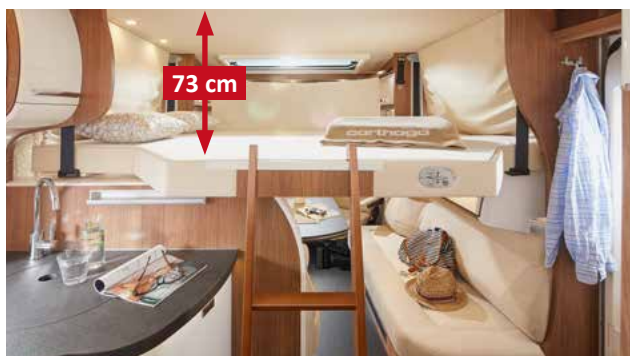
Som tilvalg sentral senkeseng: kan betjenes elektrisk, stor liggeflate, ståhøyde under seng i botilstand 184 cm
