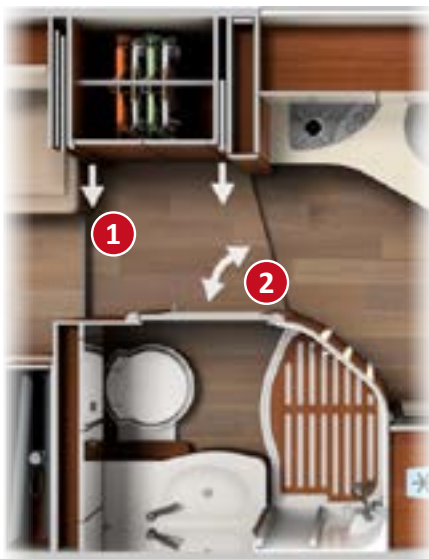
❶ Massive skyvedører i tre for romavdeling mot soverommet, ❷ svingbar baderomsdør for å skille av mot bodelen
