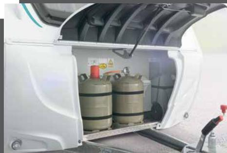
Gasskasse til 2 x 11 kg med en råtesikker riflet aluminiumsplate som bunn
