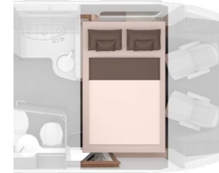
**Avslappet og nedfelt.** Senkesengen (på inntil 195 x 140 cm) har en senkemekanisme av høy kvalitet og kan lett senkes ekstra langt ned. Slik får du et separat soveområde. Når sengen ikke brukes, har du en komfortabel ståhøyde i bodelen.
