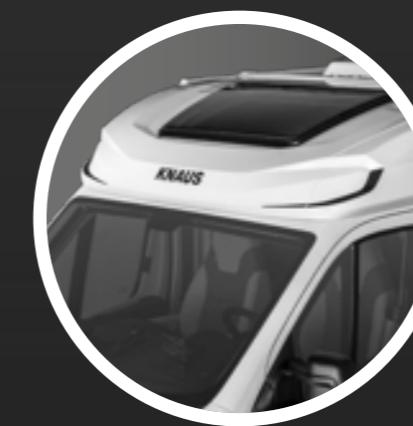
På taket til førerhuset bruker vi i VAN TT topp moderne LFI-teknologi (long fibre injection) med integrert isolasjon. Fordi vi bruker fiberforsterket polyuretan er komponentene ekstra lette, samtidig som de er stabile og motstandsdyktige selv i ekstrem varme og kulde
